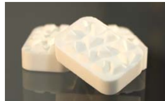
MICKE \text{Al}_2\text{O}_3 Keramiken mit Oberflächenprofil
