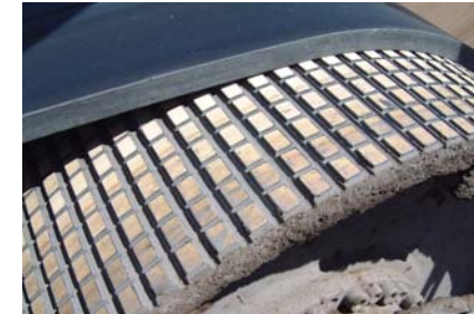
CERASINT Reibbelag auf Hecktrommel
